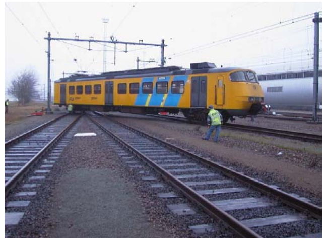
Een interessante variant op het thema ontsporing (het treinstel staat nog óp de rails). Met zeer grote, maar oppervlakkig nauwelijks zichtbare, schade tot gevolg.
