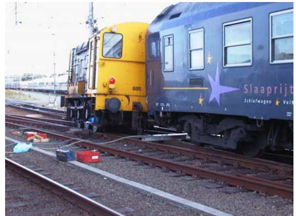
Een combinatie van ontsporing en aanrijding. Gevolg: aanzienlijke "blikshade" aan het rijtuig, een (mogelijk) beschadigd wissel en kosten voor hersporing en productiestilstand.
